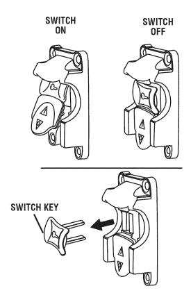
SWITCH IN LOCKED POSITION
